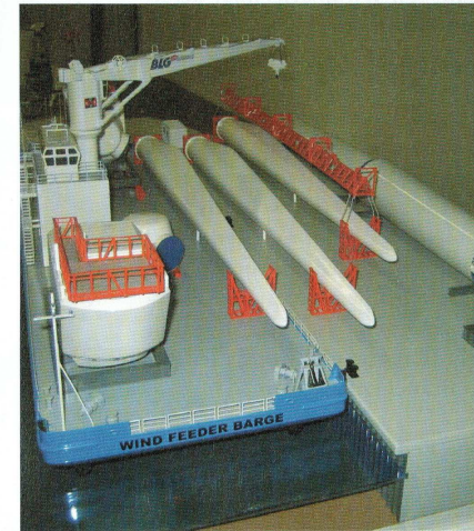
Die Wind Feeder Barge kann bis zu 90 m lange Rotorblätter oder Turmsegmente mit dem eigenen Kran transportieren
