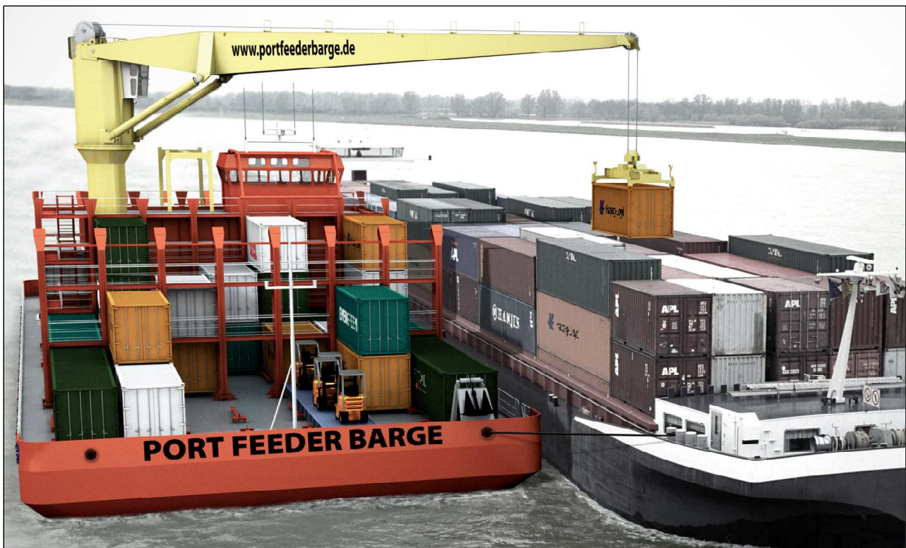
Abb. 1 Eine "Port Feeder Barge" schlägt selbständig auf ein im Strom liegendes Binnenschiff um
