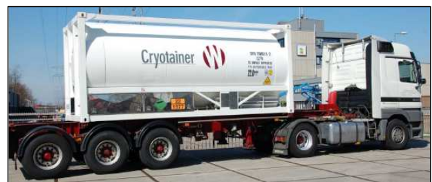
Abb. 17. 20ft-LNG-Tankcontainer (Foto: Cryotainer B.V.)
