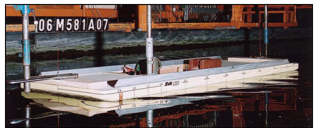
Abb. 3. Schleppversuche bei der SVA Potsdam
